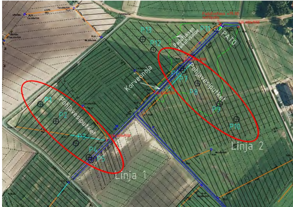
Kuva 2.12. Valtaojan padotusalue ja pohjavesiputkilinjat 1 ja 2.
